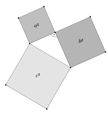
Die geometrische Deutung des Satzes von Pythagoras besagt, dass bei einem rechtwinkligen Dreieck der Flächeninhalt des Quadrates über der Hypotenuse gleich der Summe der Flächeninhalte der Quadrate über den beiden Katheten ist.
